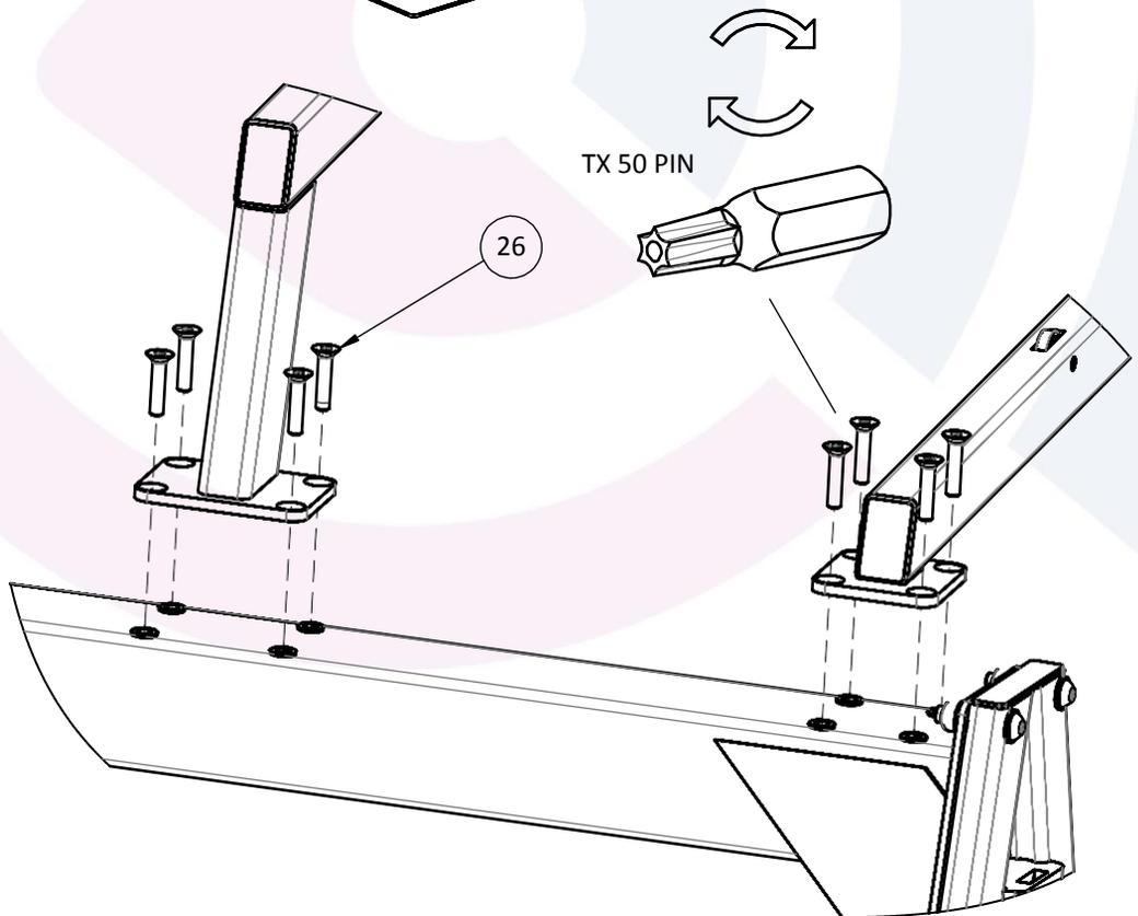
Maintenir la console jusqu'à ce que tous les boulons soient serrés. Serrez les boulons en croix
