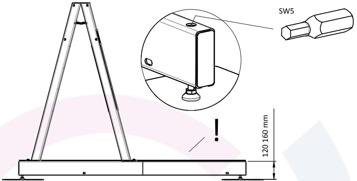
! Maintenir la structure stable et de niveau afin de limiter le bruit et les vibrations ultérieures lors de l'utilisation
