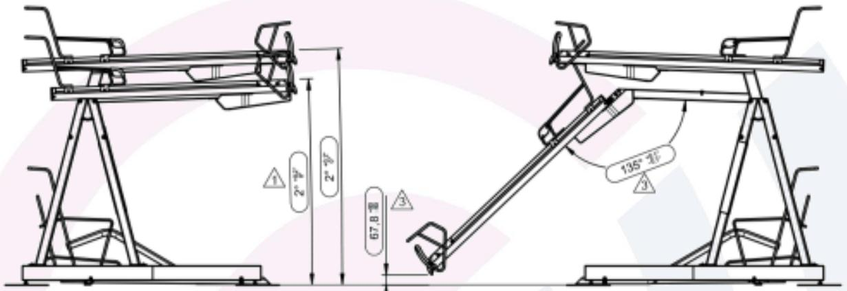
Vérifier l'angle et la hauteur pour le bon fonctionnement de la charnière
